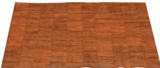
FIG.3- Pequenos pedaços de couro de Tilápia soldados formando uma manta com 100x60cm. Fonte: Kaeru
