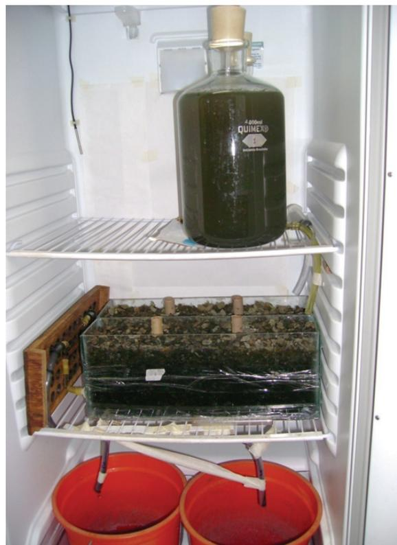
**Figura 1.** Sistemas alagados de escoamento subsuperficial horizontal (SACs), em escala laboratorial, utilizados no tratamento da água residuária da suinocultura.
