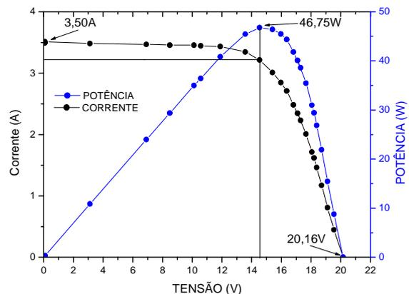
**Figura 2.** Curva característica do painel fotovoltaico em condições de campo (painel com filme de água).
