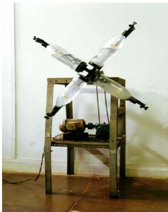
Figura 1. Esquema do agitador utilizado na lixiviação fragmentada.
