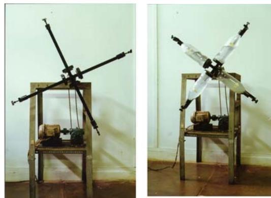
**Figura 1.** Lixiviador utilizado nos experimentos
