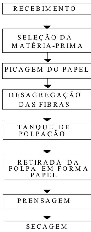
Figura 1. Fluxograma da fabricação de papel artesanal
