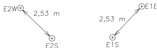
Figura 2. Locação dos dois pares de estacas ensaiadas
