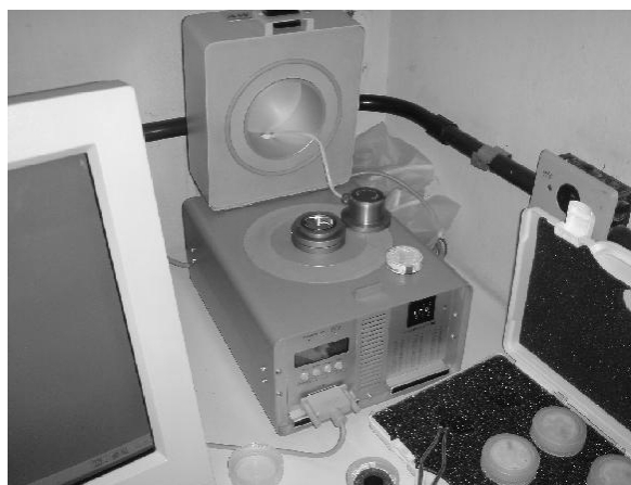
Figura 3. Equipamento para determinação das isotermas - Novasina AW Sprint®.
