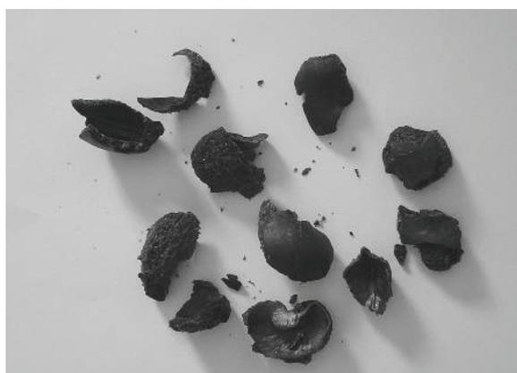
**Figura 1.** Cascas de castanha após decorticação: bagaço de pedaços não-uniformes.
