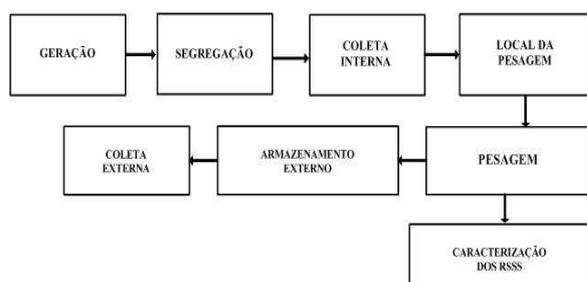
Figura 1. Seqüência das atividades realizadas na operação de caracterização do RSSS.
