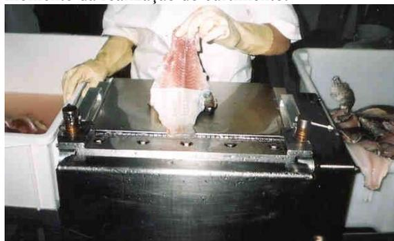
**Figura 1.** Máquina utilizada para a remoção das peles dos filés de carpa espelho.
