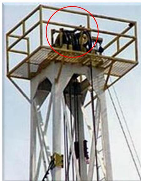
Figura 2. Posição do 'bloco de coroamento' (Crown block, 2021).
