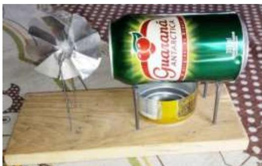
Figura 03: Experiência da máquina térmica.
