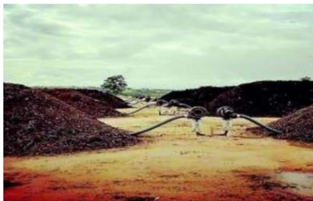
Figura 6 – Compostagem de aeração forçada (Fonte: Silva, 2018, p. 30).
