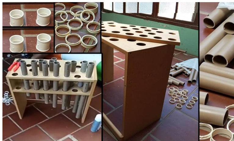
Figura 5. Desenvolvimento da construção do Piano Percussivo.
