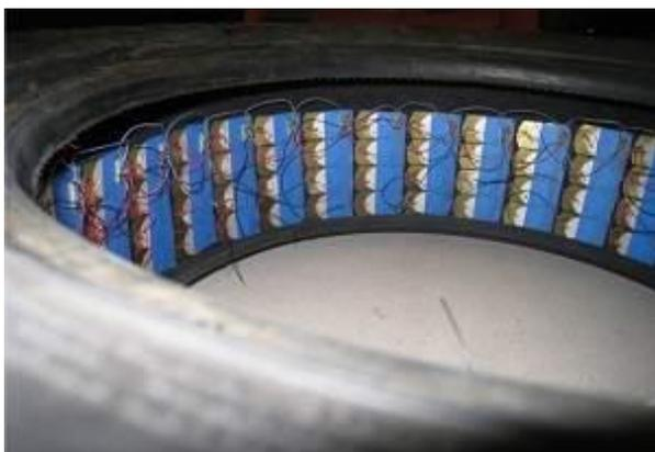
Figura 3 – Pneu com nanogeradores piezoelétricos, (PELINGEIRO *et al*, 2016)
