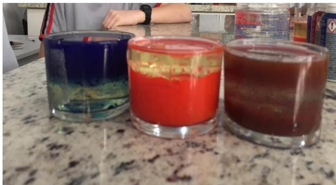
Figura 3: Exemplos de mistura heterogênea: óleo vegetal na mistura de água com corante vermelho; óleo na mistura de álcool e corante azul; óleo no recipiente com a mistura de água com corante vermelho e álcool com corante azul.
