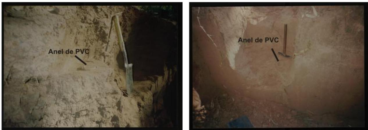
**Figura 4:** Ilustração dos perfis de solo e coleta indeformada dos materiais nos anéis de PVC.
