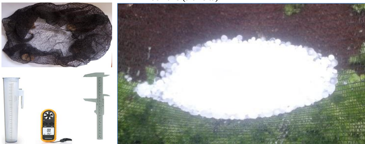
Figura 4: Ferramentas utilizadas (à esquerda) e granizos concentrados na armadilha em 23 de abril de 2018 (à direita)
