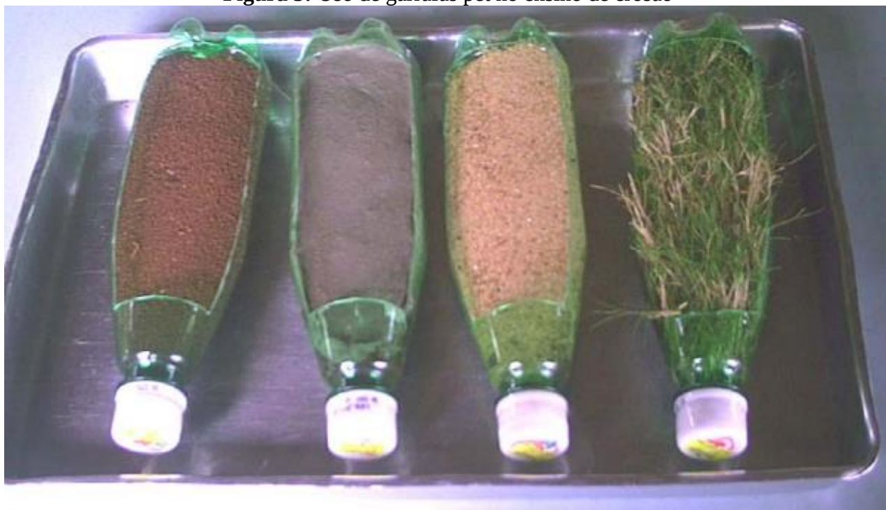
Figura 5: Uso de garrafas pet no ensino de erosão
