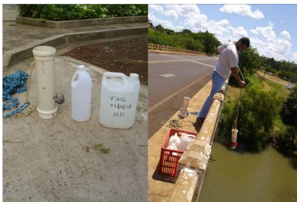
Figura 11: Coleta de água para análise de sedimento suspenso no rio Ivaí, ponte de Porto Ubá com coletor pontual de garrafa.
