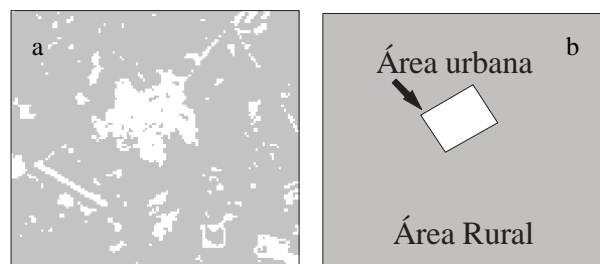
Figura 4: a) classificação baseada nos números digitais da imagem, a cor branca representa áreas urbanas e a cor cinza representa áreas rurais; b) classificação dos dois temas a partir de interpretação visual e reconhecimento em campo.
