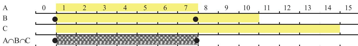
**Figura 2 - Restrição de matéria-prima da liga tipo "A"**
