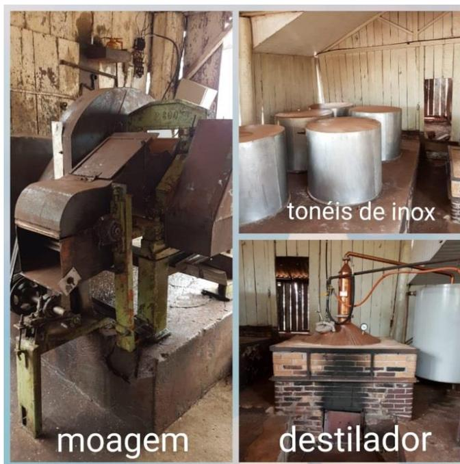
**Figura 3: Galpão de moagem, Fermentação e Destilação da Cachaça Bassi.**
