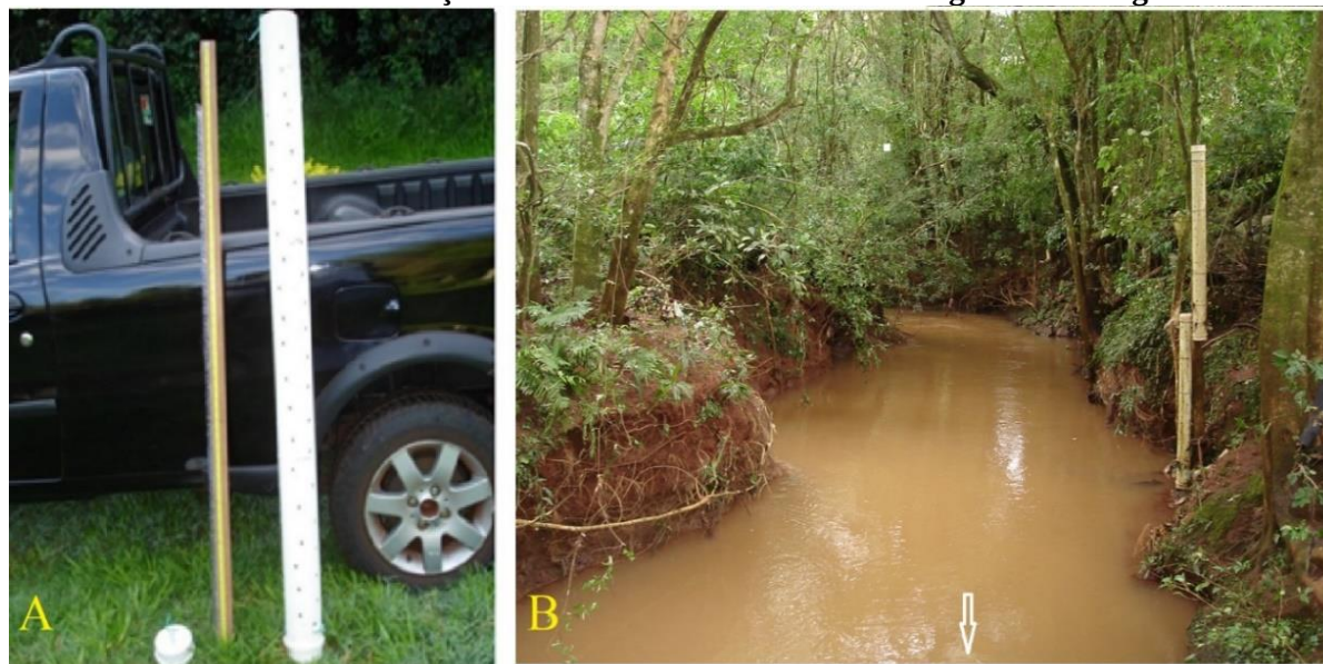
Figura 6 - A) Régua de máxima (esquerda) e tubo protetor de PVC (direita). B) Conjunto de réguas de máximas instalado na seção transversal de referência na margem do córrego Guavirá
