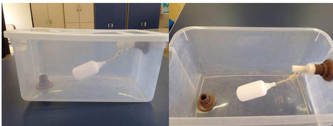
**Figura 4- Protótipo do micro reservatório social para redução de pressão.**
