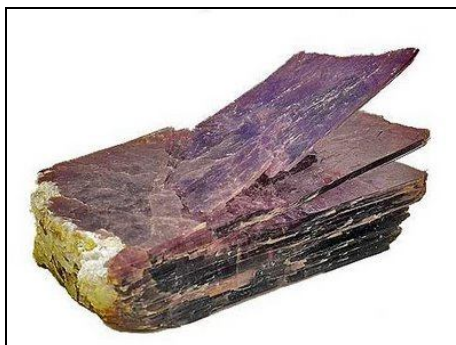
Figura 4: Clivagem de mica em lâminas paralelas Fonte: http://maisbiogeologia.blogspot.com.br/2009/03/rochas-sedimentares-minerais-e-sua.html (2015)
