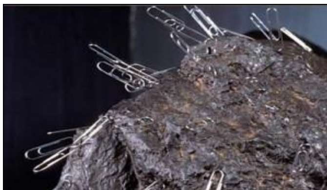
Figura 9: A ação magnética da magnetita
