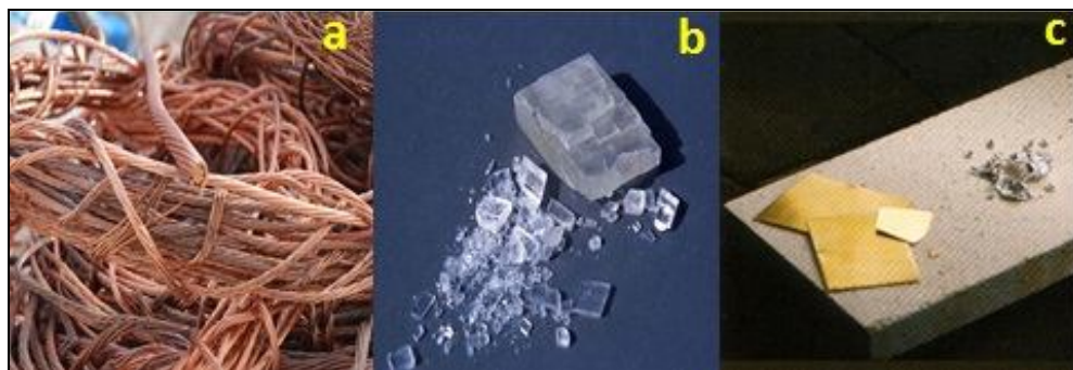
Figura 13: A tenacidade do cobre ( a = dúctil), da calcita ( b = quebradiça) e do ouro ( c = maleável) Fonte: SEGEP / UEG (2015)
