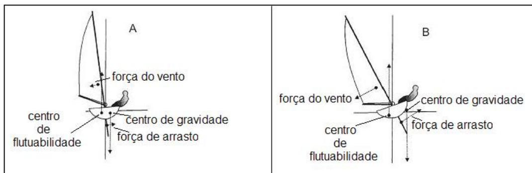
**Figura 1-** Representação esquemática das forças envolvidas no movimento de escora em diferentes condições de vento: fraco (A) e forte (B).
