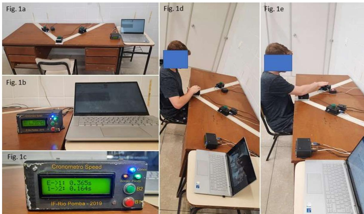
**Figura 1.** Equipamento SPEED. 1a: Disposição dos botões do equipamento Speed; 1b: Display de LCD acoplado ao notebook via bluetooth; 1c: Cronômetro do equipamento Speed; 1d: Posição inicial do teste com a mão no botão de acionamento; 1e: Posição final do teste com a mão no botão de desligamento após acender sensor luminoso.
