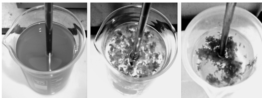
Figura 5. Aspecto geral da formação dos flocos após a adição do coagulante
