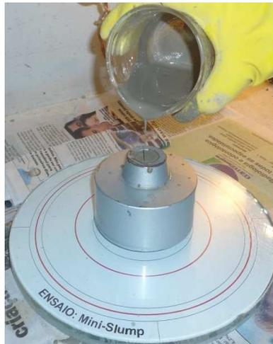
**Figura 2.** Ensaio de Mini-Slump
