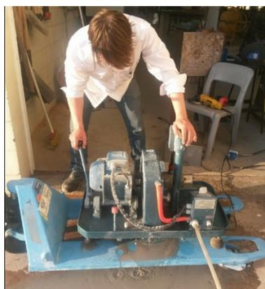
**Figura 7.** Retificação dos corpos de prova.
