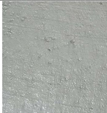
**Figura 12.** Aspecto do concreto das placas logo após a moldagem.
