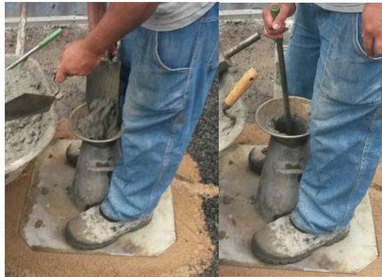
**Figura 1.** Determinação da consistência através do ensaio de abatimento de tronco de cone realizado na obra para concretagem da laje do 7º pavimento.
