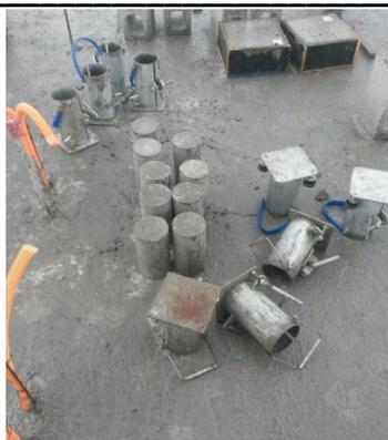
**Figura 6.**Corpos de prova na laje do 7º Pavimento: desmoldagem.
