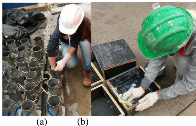
**Figura 3.** Aplicação de desmoldante nos corpos de prova. (a) Corpo de prova cilíndrico – forma metálica. (b) Placa – forma de madeira.
