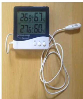
**Figura 5.** Termohidrômetro digital utilizado para aferir a temperatura e a umidade relativa do ar no dia da moldagem.
