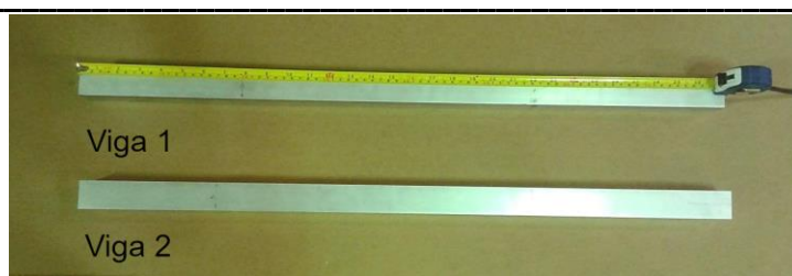
Figura 3. Vigas de alumínio usadas nos ensaios.
