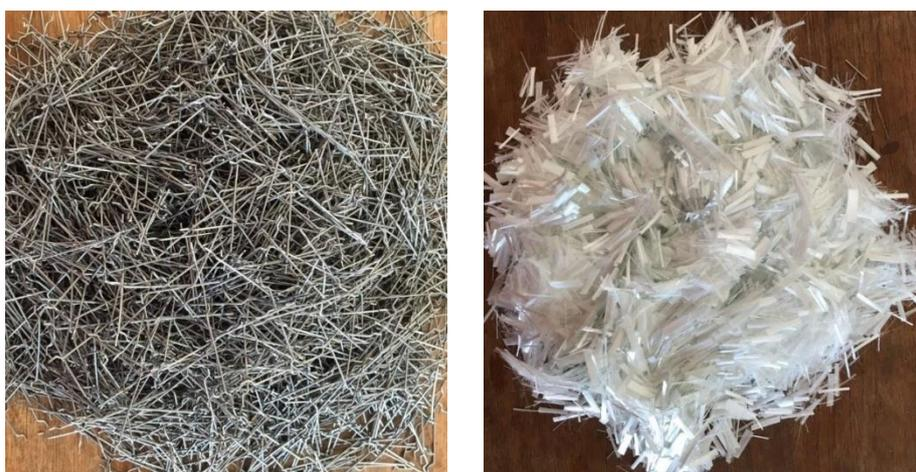
**Figura 2.** Fibras de aço e de vidro (Fonte: Autoria própria, 2017)
