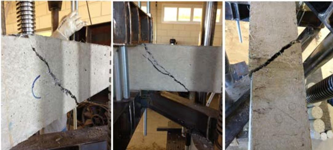
**Figura 4.** Rupturas típicas por torção das vigas com fibras.
