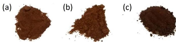
**Figura 3.** Amostras do rejeito (a) Puro; (b) Flotado e (c) Não flotado para a polpa com concentração de 50%.
