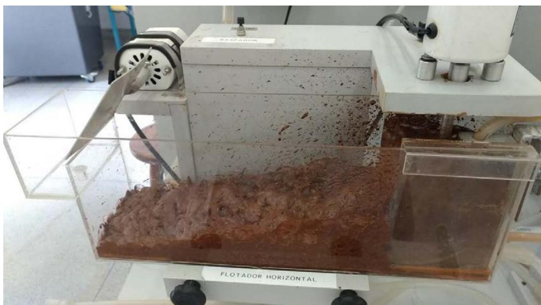
**Figura 1.** Flotação do rejeito.
