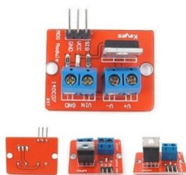
**Figura 4:** Módulo Power MOSFET IRF520
