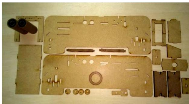
**Figura 2:** Componentes estruturais da esteira.
