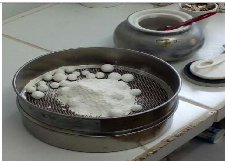
**Figura 2.** Material após moagem para peneiramento.
