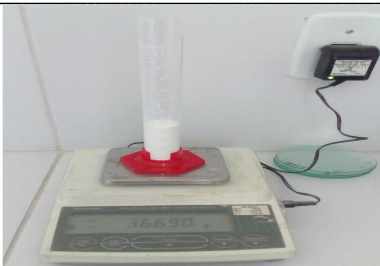
**Figura 3.** Ensaio da determinação da densidade.
