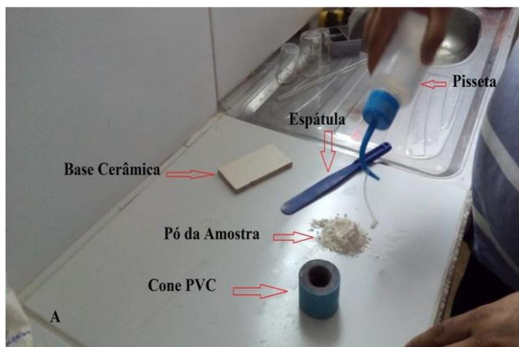
**Figura 4.** Preparação do molde e conformação do cone.
