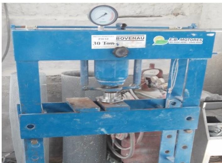
**Figura 5.** Detalhe da prensagem da pastilha.
