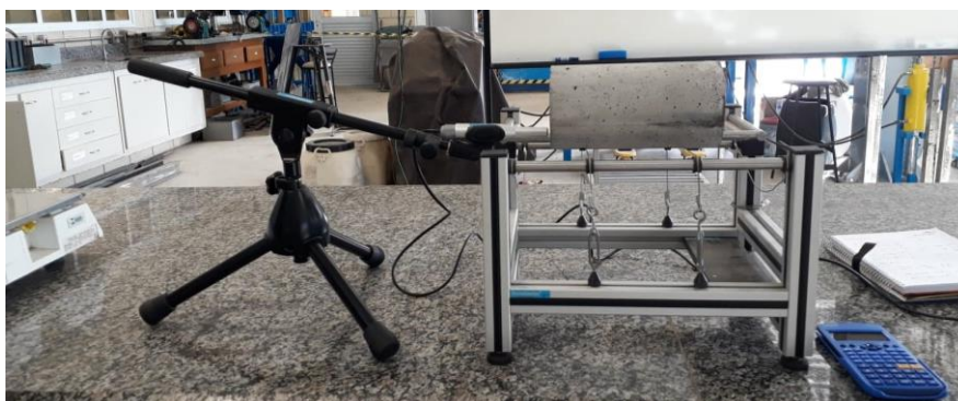
Figura 3. Equipamento para a realização do ensaio de módulo de elasticidade dinâmico Fonte: Autores, 2020.
