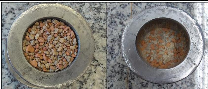
**Figura 9.** Amostra de pedregulhos de RCC antes e após ensaio de compressão unidimensional. Fonte. Próprios autores (2020).
