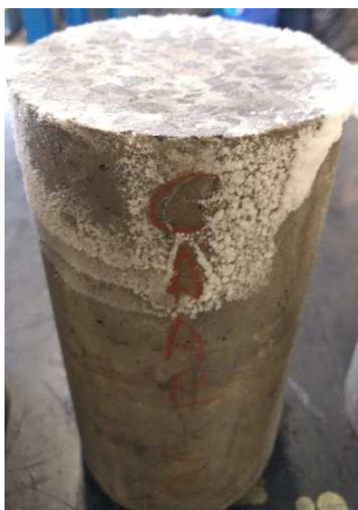
Figura 4- Cristalização de sais na superfície exposta do corpo de prova
