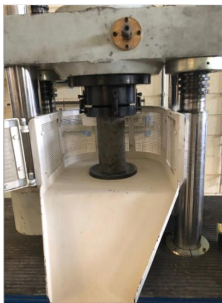
Figura 4. Corpo de prova submetido à compressão axial
