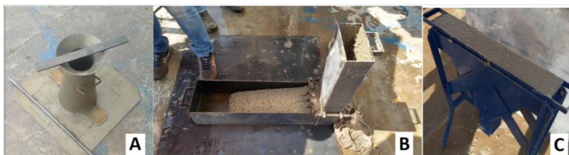
Figura 2. Ensaio de caracterização do concreto no estado fresco – a) Slump-flow test, b) caixa-L, c) Funil-V.
