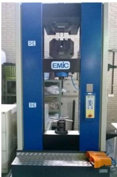
**Figura 4.** Máquina Universal de Ensaios
