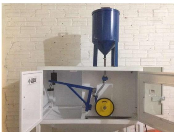
**Figura 6.** Abrasômetro com roda de borracha localizado no LdTM (UFRGS)
