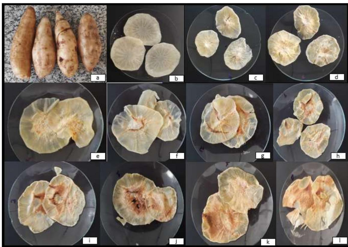
**Figura 3.** Fotos das amostras de batata yacon desidratadas em micro-ondas nos diferentes tempos de processo, onde: a – *in natura*; b – 0 s; c – 30 s; d – 60 s; e – 90 s; f – 120 s; g – 150 s; h – 180 s; i – 210 s; j – 240 s; k – 270 s; l – 300 s.
