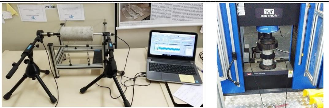
**Figura 5.** Determinação do módulo de elasticidade - ensaio não-destrutivo por técnica de excitação por impulso e ensaio convencional destrutivo por compressão axial.
