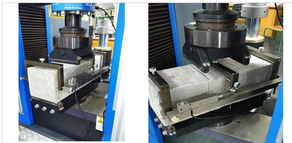
**Figura 6.** Ensaio de flexão em corpos de prova prismáticos
