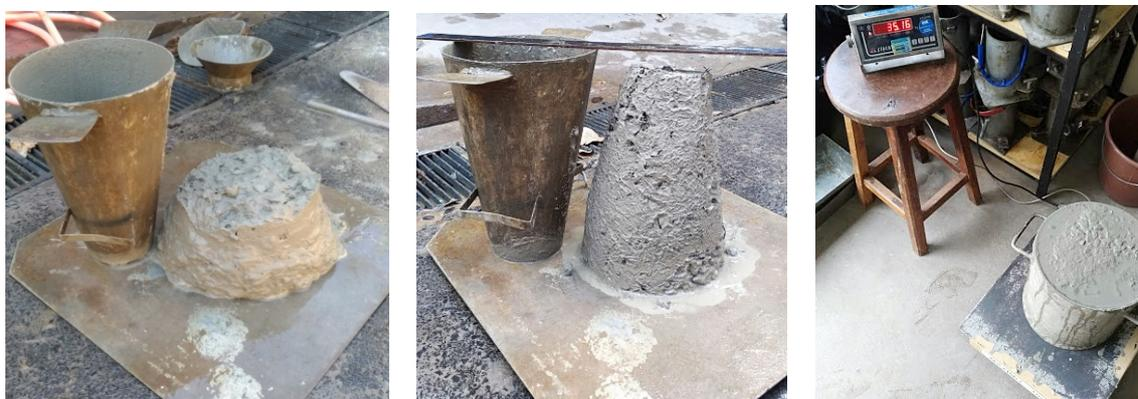
Figura 3. Ensaio no estado fresco: consistência e massa específica
