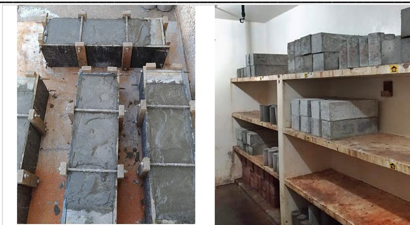
**Figura 4.** Corpos de prova após a moldagem e armazenados em câmara úmida
