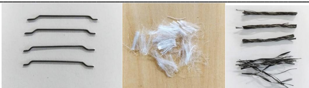
**Figura 2.** Fibras de aço e de PP (macro e microfibras).
