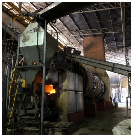
**Figura 5** - Secador rotativo de erva-mate (a). Folhas e ramos diretamente em contato com as chamas (b)
