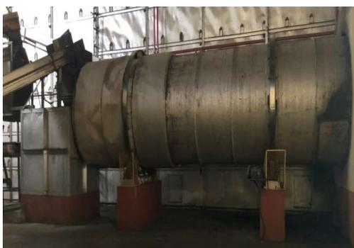
*Sapegador 02 (Esteira)*: as amostras foram coletadas na saída do sapecador 02 com temperatura média de 66°C, onde as chamas do sapecador foram alimentadas automaticamente com cavaco de eucalipto de reflorestamento. Neste processo a erva-mate passa por um cilindro metálico giratório e inclinado (Scheffel) de 2,5 m diâmetro e 7 m de comprimento (Figura 4).
