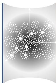
**Figura 3.** Arraste do soluto A devido ao movimento do meio B: as esferas brancas são representativas do soluto, enquanto os pontos representam o meio [14].
