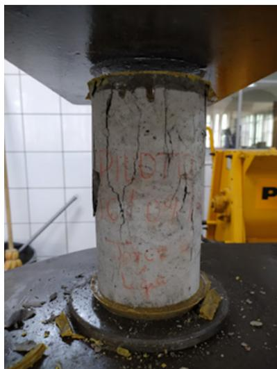
**Figura 6.** Corpo de prova após a ruptura.
