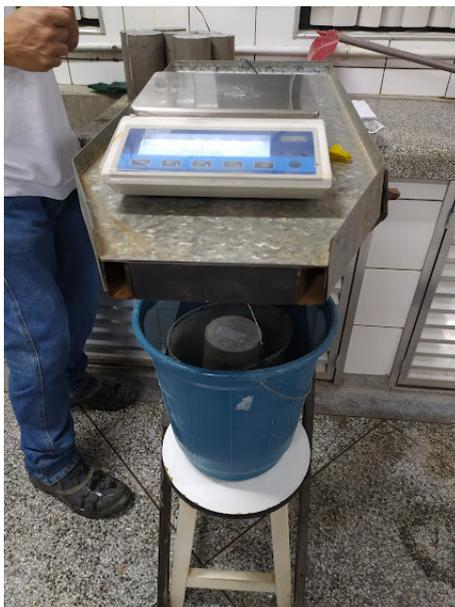
**Figura 8.** Aferição da massa imersa do corpo de prova.
