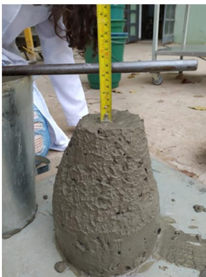
**Figura 5.** Ensaio de abatimento do tronco de cone.
