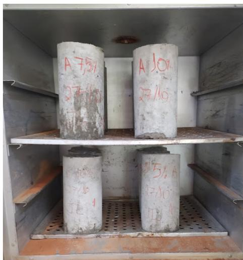
**Figura 7.** Corpos de prova na estufa.
