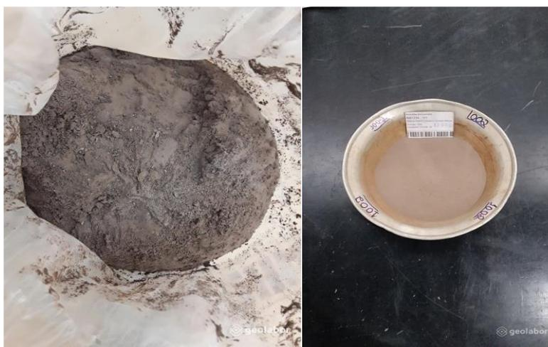
**Figura 1:** Rejeito de minério de ferro em estado úmido (esquerda) e em estado seco (direita). Fonte: próprios autores (2024)
