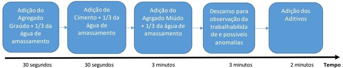
**Figura 4:** Procedimento de mistura do concreto em laboratório. Fonte: próprios autores (2024)
