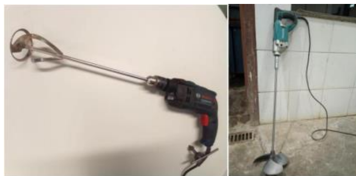
Figura 1. Equipamentos para mistura da espuma e do concreto.
