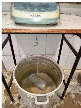
Figura 5. Ensaio de absorção por imersão do concreto.
