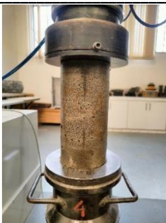
Figura 4. Ensaio de resistência à compressão do concreto.
